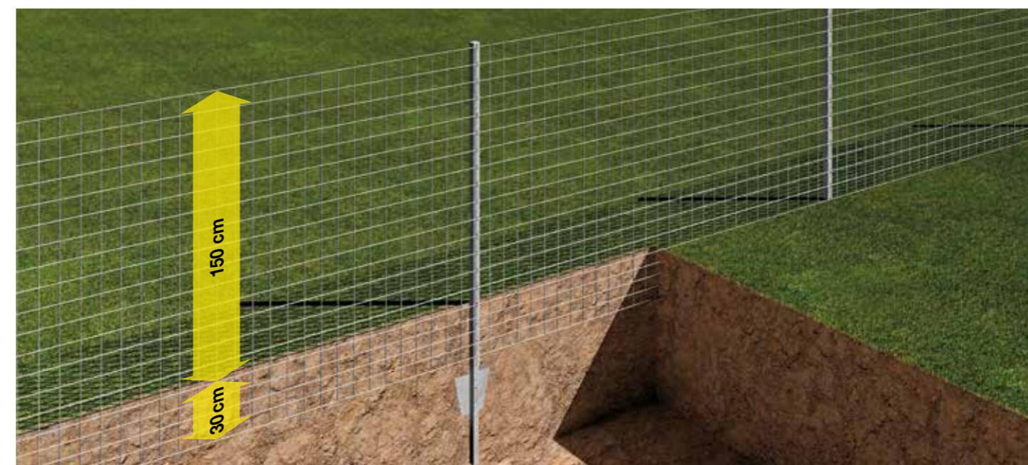
clôture Mastertec h 180 cm enterrée - exemple d'installation type
